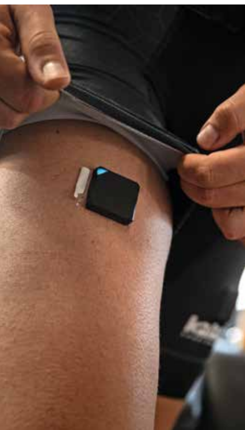
Senzory s funkcí akcelerometrů a gyroskopů současně, které se kromě stehien umísťují na nártu a kříž, snímají jak polohu končetin, tak jejich zrychlení
